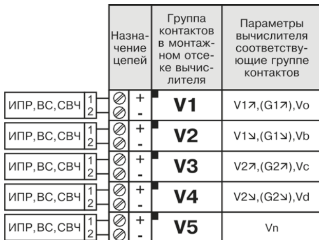
Рисунок В.1 – Схема подключения к вычислителю ИПР, ВС, СВЧ
